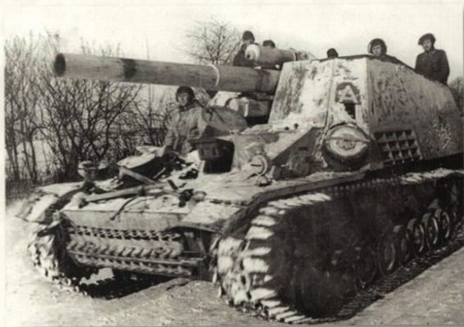
Hummel con camuflaje invernal y orugas especiales para circular por nieve y barro, denominadas "Ostketten" ("cadenas del Este").
