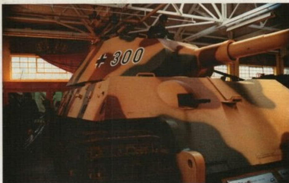
Tiger Ausf. B con torreta Porsche; todos todas las unidades de esta versión salieron de fábrica recubiertos de Zimmerit (cemento antimagnético).
