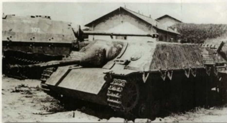
■ Jagdpanzer L/70 protegido con dos capas de pasta antimagnética Zimmerit.
