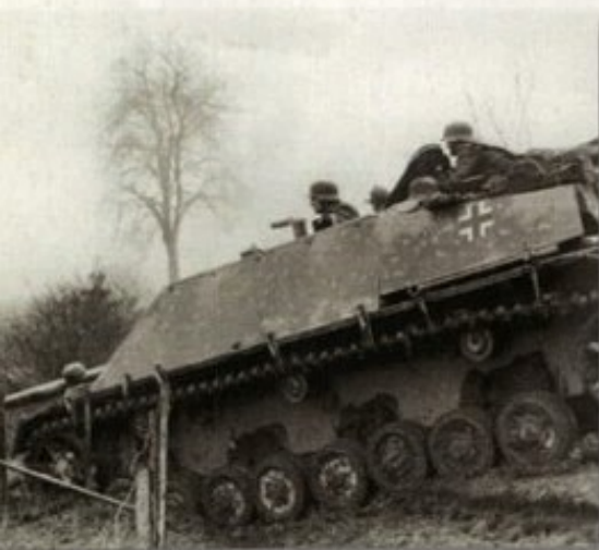
■ Para fabricar el L/70, se utilizó el chasis modificado del versátil tanque Pz. IV en sus versiones Ausf. H y Ausf. J.
