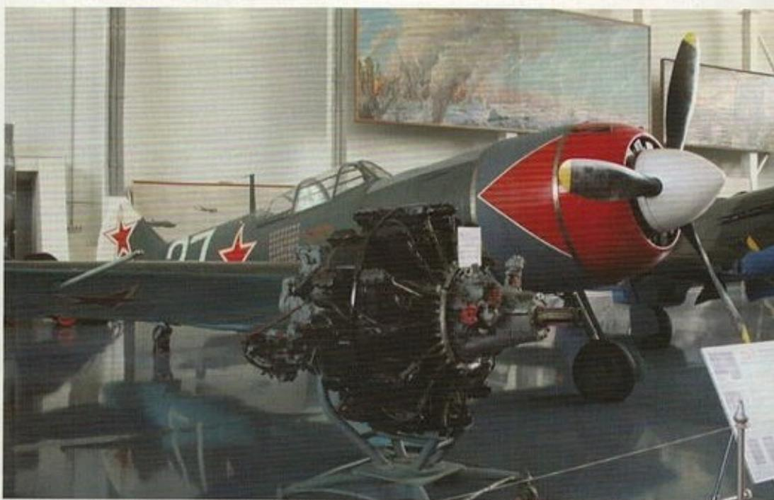
**MOTOR RADIAL** El motor Shvetsov ASh-82FN tenía 14 cilindros radiales en dos filas y empujaba 1650 hp, suficientes para un avión de 3300 kg de peso.
