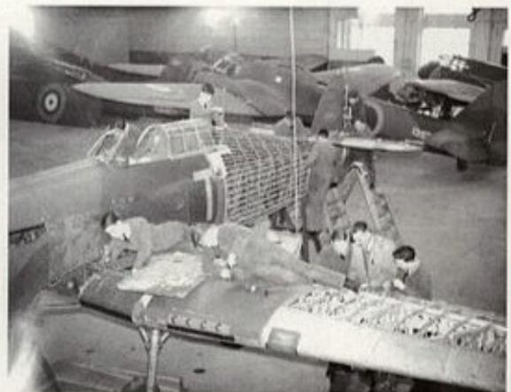
**TUERCAS Y BULONES** Mecánicos aprendices ajustan la estructura sencilla pero resistente de un Hurricane en la Escuela Técnica N°2, en Cosford, Inglaterra.
