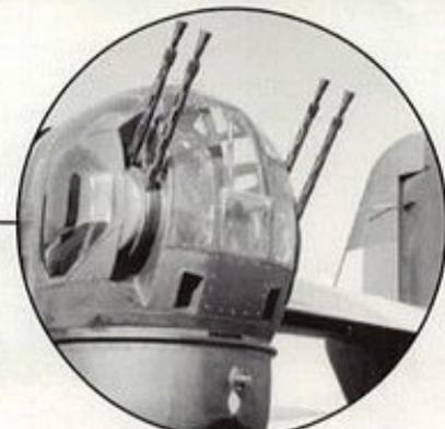
Detalle de la torreta de cola con las cuatro ametralladoras Browning. Era accionada por un sistema electro-hidráulico.
