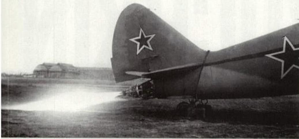
**EXPERIMENTAL** La variante La-7R incluyó un cohete de combustible líquido RD-1KhZ en la cola, que le daba 80 km/h extra.
