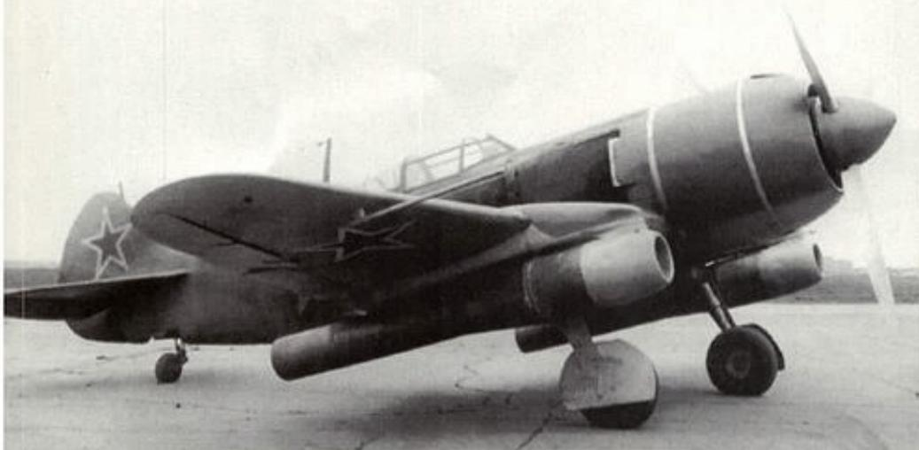
**POTENCIA EXTRA** El La-7PVRD y el La-9 incorporaron dos turbinas jet subalares que le podían dar hasta 119 km/h más a los 660 que alcanzaba de velocidad máxima.
