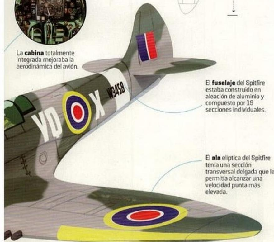
El **fuselaje** del Spitfire estaba construido en aleación de aluminio y compuesto por 19 secciones individuales.
