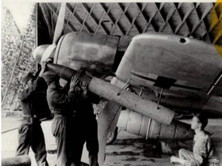
**CAZA MULTIPROPÓSITO** Los Fw 190A-8 podían cargar cohetes subalares para dispersar formaciones de bombarderos aliados, y tanques auxiliares ventrales de 300 litros de combustible.
