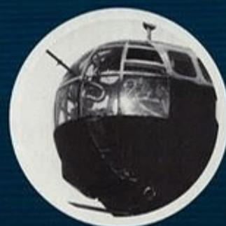
**LA CABINA VIDRIADA** del He 177 con uno de los puestos de ametralladora calibre 7,92.
