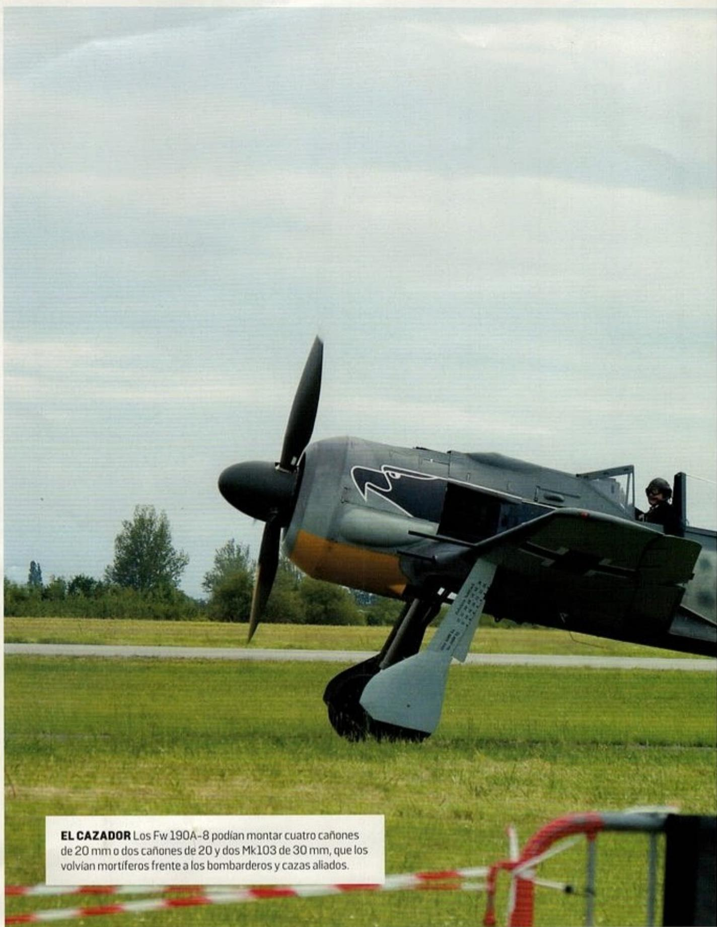
**EL CAZADOR** Los Fw 190A-8 podían montar cuatro cañones de 20 mm o dos cañones de 20 y dos Mk103 de 30 mm, que los volvían mortíferos frente a los bombarderos y cazas aliados.
